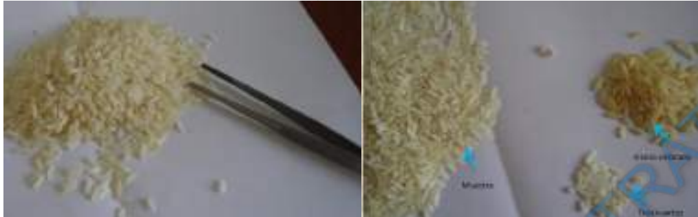
Figura 2.12: Separación y clasificación de grano de arroz partido, extraída de una muestra
