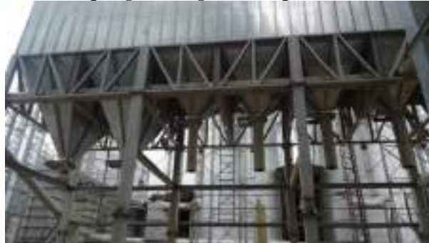
Figura 4.3: tolvas de descargue para despacho de grano en Planta de Cuatro Cañadas
